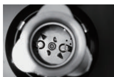
4.用較長較硬的棍子(如螺絲刀等)觸及研磨盤將其來回轉動
